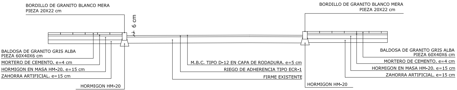
Sección D-D. Detalle de sección de firme SECCIÓN VIA
